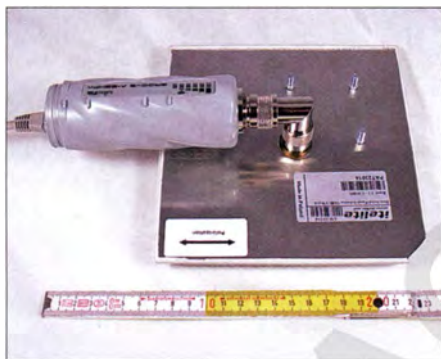
Bild 3: Ein geeigneter WLAN-Transceiver mit Patch-Antenne; der Anschluss ist ein normales Netzwerkkabel, das bis zu 100 m lang sein darf. Fotos: DL4NO
