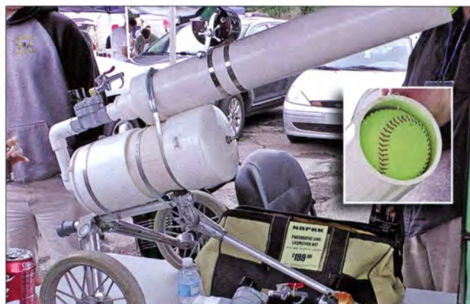
Diese pressluftbetriebene Schussanlage für Antennendrähte dürfte wohl kaum auf den deutschen Markt kommen.
