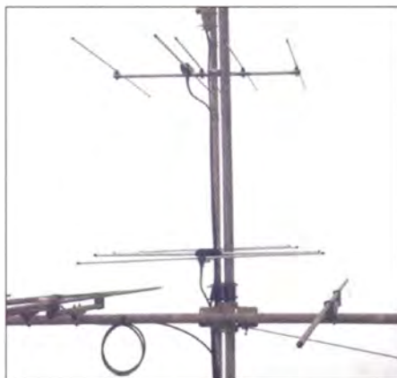
Auch mit kleinen Antennen kann man große Distanzen überbrücken: die zwei 5-Element-Yagi-Antennen von D4C/B. Fotos: D4C
