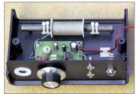
Bild 13: Dieses kleine Gewitterwarngerät gibt bei DFE-Detektion akustische und optische Signale ab.
