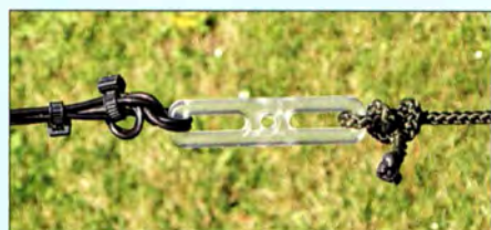
Bild 13: Endisolator; links Dipolende, rechts Abspannseil
