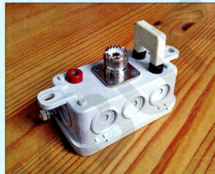
Bild 8: Einspeisebox, rechts Steckbrücke, Mitte PL-Buchse zum Transceiver, links eine der Buchsen für symmetrischen Antennenkoppler
