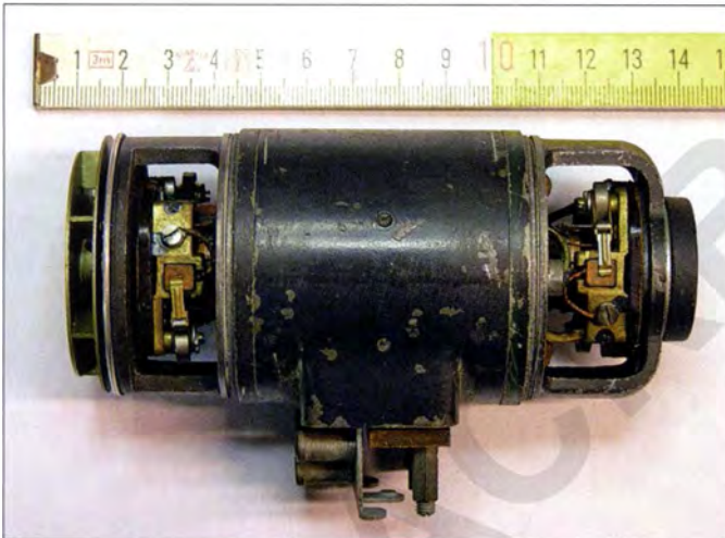
Bild 1: Dieser Einanker-Umformer diente zur Stromversorgung eines röhrenbestückten Empfängers; rechts befindet sich der Bürstensatz des Elektromotors, links der des Generators, ganz links das Kühlgebläse. Die Endkappen wurden entfernt.
