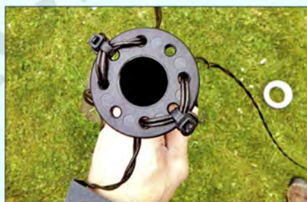
Bild 12: Befestigung der Antennenleiter am Mittelisolator
