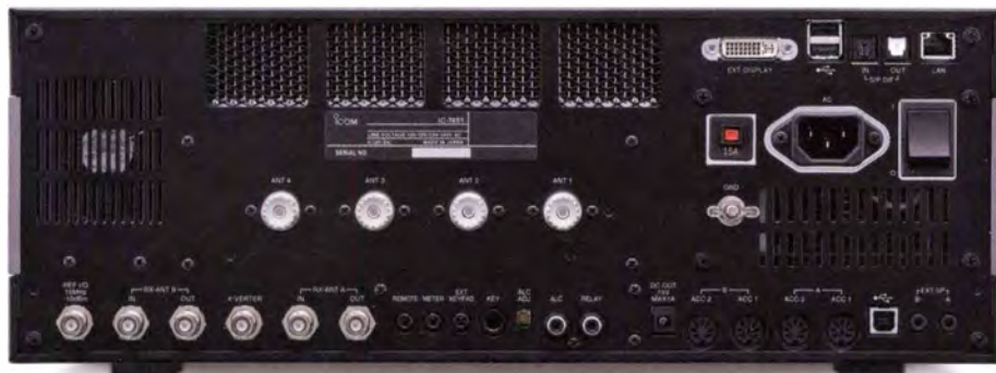
Bild 8: Die Anschlussmöglichkeiten sind zeitgemäß und lassen keine Wünsche offen. Die Buchsen sind anders als beim IC-7800 angeordnet. Fotos und Screenshots: Werkfotos
