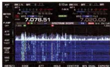
Bild 5: Displayanzeige mit Spektrumdarstellung und darunter angeordnetem Wasserfalldiagramm (Wide Screen)
