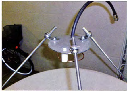
Bild 4: Erreger mit Ringdipol (unter der PTFE-Scheibe) und Anschlusskabel mit Stecker
