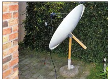
Bild 3: Parabolantenne mit LNA im fertig aufgebauten Zustand
