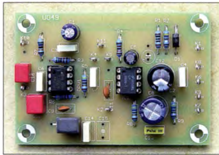
Bild 16: Verstärkerplatine UO49 mit zwei FKP2-Kreiskondensatoren (links) und LC-Filterbeschriftung, siehe Text
