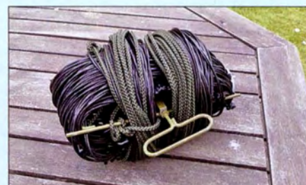
Bild 5: Ohne Mast und Heringe wiegt die komplette Antenne mit Einspeisebox und Haspel nur 1400 g.
