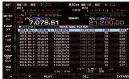
Bild 7: Liste der bei eingeschalteter File-Split-Funktion automatisch gespeicherten QSO-Dateien mit Meta-Daten
