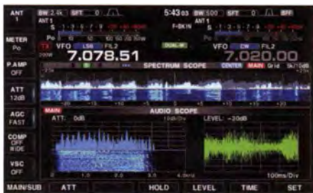
Bild 4: Miniskop (Spektrum und Wasserfall) sowie eingblendetes Audioskop (Spektrum und Wasserfall) und Oszilloskop
