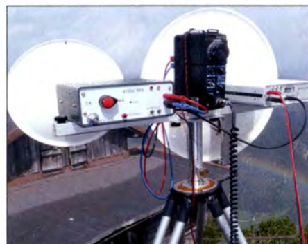
Sommer-BBT 2015 im Allgäu – die 24/47-GHz-Anlage bei Horst, DL4SBK, im Einsatz Foto: DL4SBK
