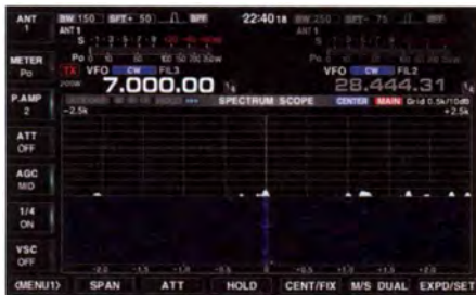
Bild 6: Anzeige eines Trägersignals mit einem Pegel von -137 dBm auf 7,000 MHz, der im Wasserfall eindeutig erkennbar ist
