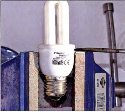
Bild 3: Das Öffnen des Lampensockels mit einem Schraubendreher muss vorsichtig erfolgen, damit der Glaskolben nicht splittert.
