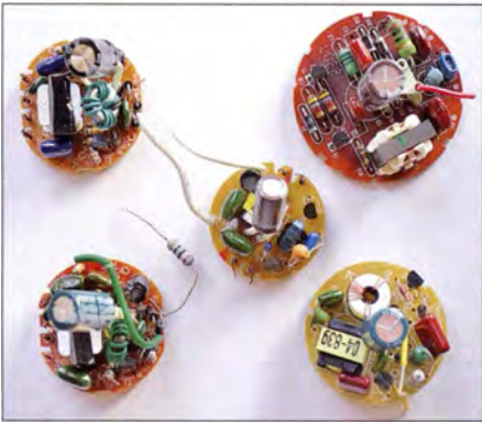
Bild 4: Die aus den Energiesparlampen entnommenen Starterplatinen basieren alle auf der Schaltung nach Bild 2.
